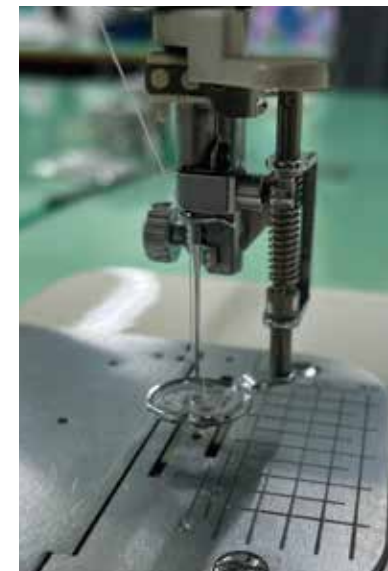
普通押さえでは生地が釣ってしまうためキルト押さえを使用 キルトで厚みがあるため縫うのが難しく1日で大量のミシン針を折る
