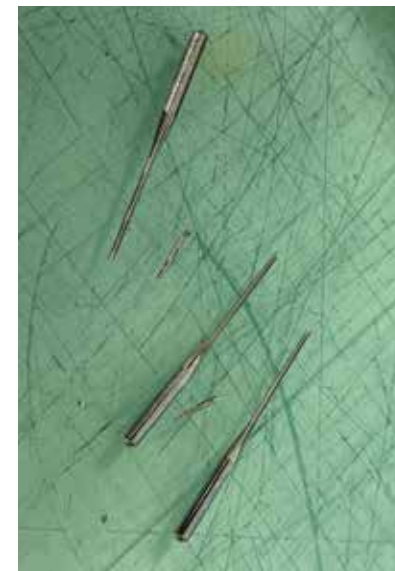
普通押さえでは生地が釣ってしまうためキルト押さえを使用 キルトで厚みがあるため縫うのが難しく1日で大量のミシン針を折る
